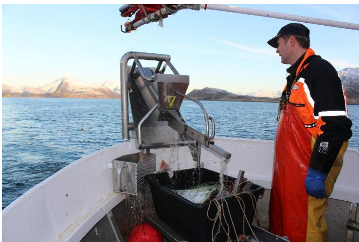
Figur 8. Setting av klavet monofilamentline gjennom egnetrakt.
